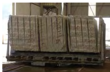
Bloque de granito cortado con telar
